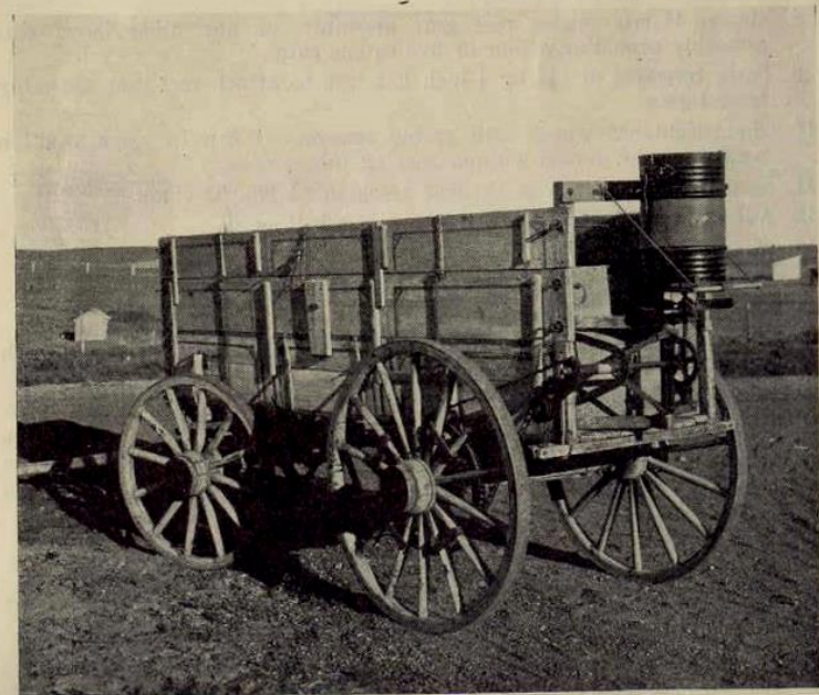
FIG. 4.—Endgate bait spreader.
